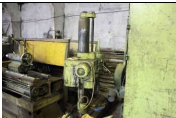
Фото 8 Станок радиально сверлильный 2К52
