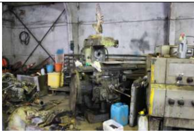
Фото 12 Станок консольно-фрезерный, универсальный 6P81
